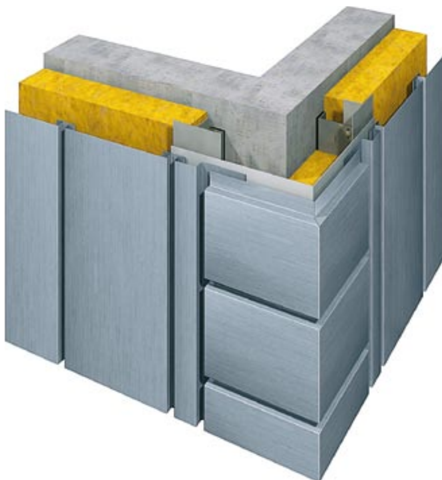
Afbeelding 8.11: Buitenhoek (combinatie horizontaal en verticaal toegepast plankpaneel)
